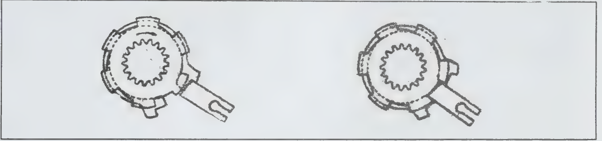
படம் 4. அ) சூரியப் பல்சக்கரம் விடுவிக்கப்பட்ட நிலையில் ஆ) சூரியப் பல்சக்கரம் சுழற்சி தடைப்பட்ட நிலையில்
